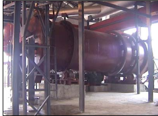
图3. 转鼓流化床工业造粒装置
